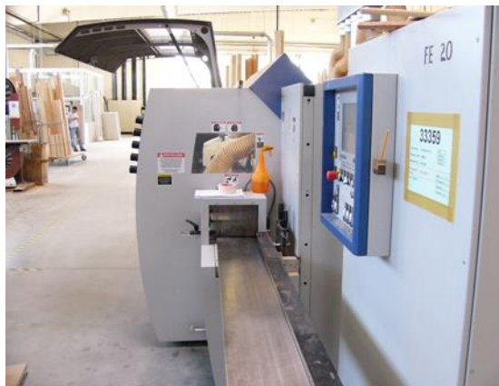
16. kép: Többfejes Weinig Powermat 6 fejes gyalugép
