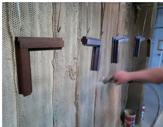
14. kép: Fedőréteg felvitele szórással
