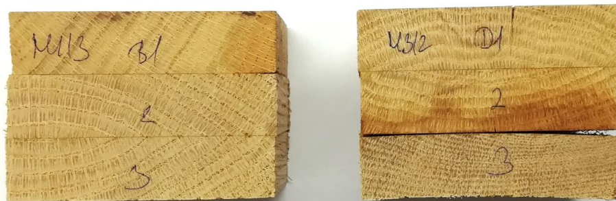
3. ábra: Szimmetrikus (bal oldal) és kevésbé szimmetrikus (jobb oldal) évgyűrűjű fa elemek összeragasztása közötti különbség. Az alkalmazott ragasztó minősége a két ragasztásnál megegyezik. Mindkét mintatest esetében a 4.1. fejezetben részletezett delaminációs tesztet végeztük el. A fatesteket ragasztás előtt 23 °C-on, 50 % relatív páratartalom mellett, 7 napon keresztül klimatizáltuk.
