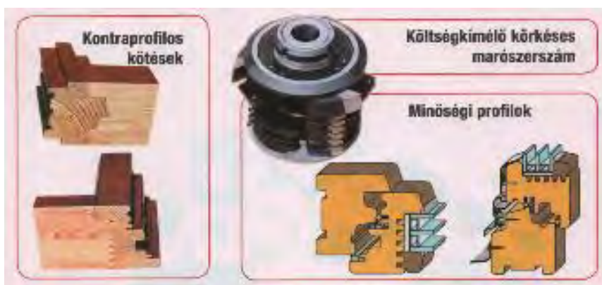
57. ábra. Ollóscsapos és kontraprofilos ablak sarokkötés
